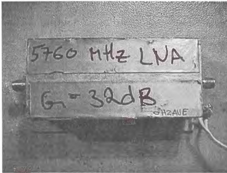
Kuva: 5.7 GHz:n etuvahvistin on rakennettu peltikoteloon ja on varustettu SMA-liittimin
