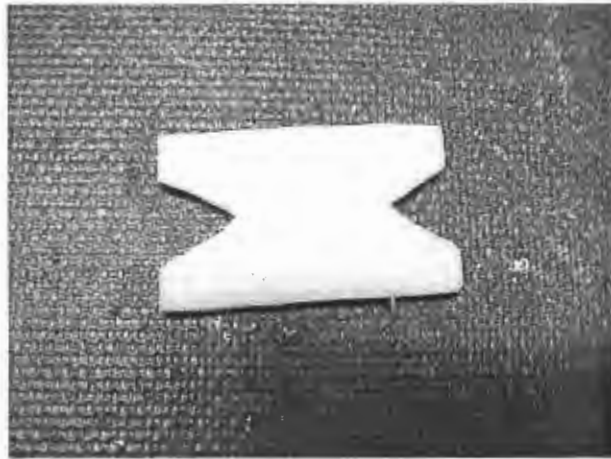
Kuva 8: Valmis teflonlevy ennen asennusta
