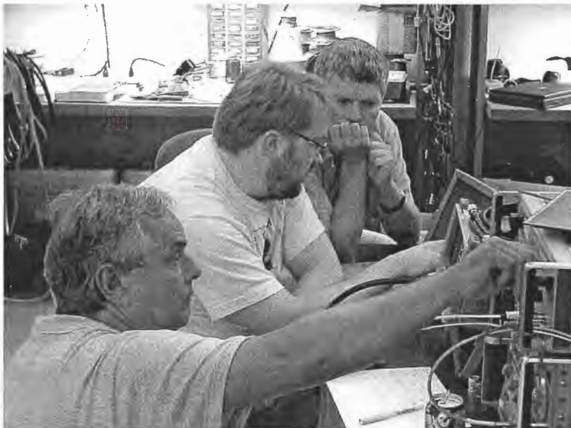
Kuva 14: OK1AQK, OH2AUE ja S53MV suorittamassa satelliitin vastaanotinmittauksia tärinä- ja jyskytystestien jälkeen. kuva: Wilfried Gladish, AMSAT-DL
