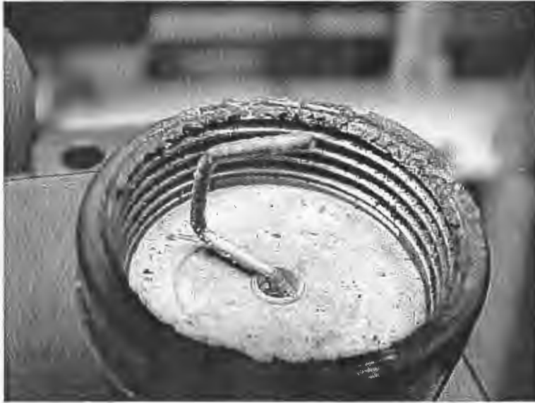
Kuva 10: Pyörivä sondi syöttötorven pohjalla
